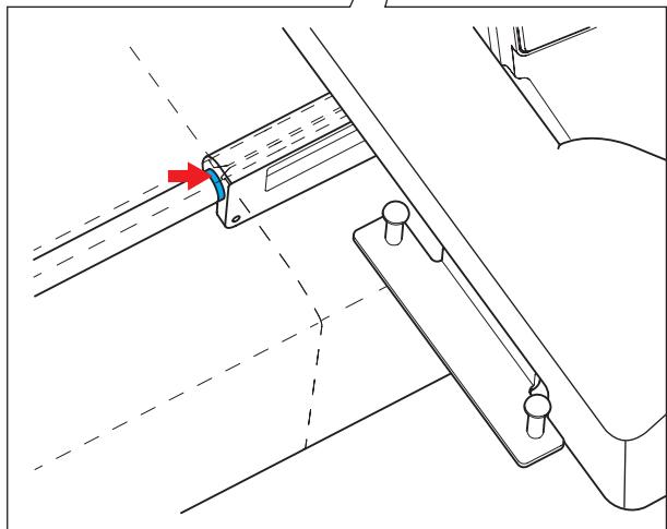
Lubrique el punto de flecha (fieltro) en el interior de la hendidura de carro.
