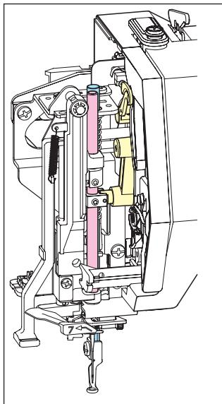
4 Lubrique los puntos de flecha como se indica en la ilustración.
