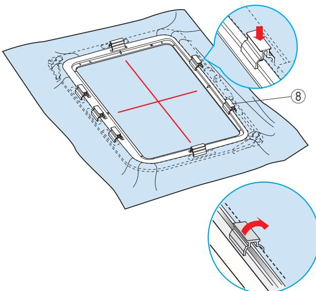
6 Sujete la tela en el bastidor con las sujetaciones.
