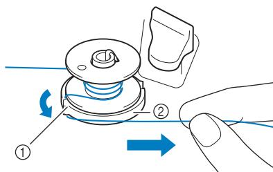
① Ranura de la guía (con el cortador integrado)
