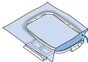
**4** Estire suavemente la tela para tensarla y apriete el tornillo de ajuste del bastidor para evitar que la tela se afloje después de estirarla.
