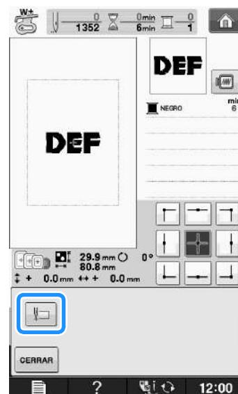
→ La aguja se coloca en la esquina inferior izquierda del patrón. El bastidor se mueve para que la aguja se coloque correctamente.
