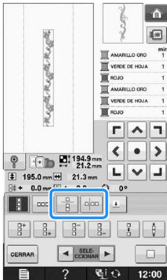
→ El indicador de dirección del patrón cambiará según la dirección seleccionada.
