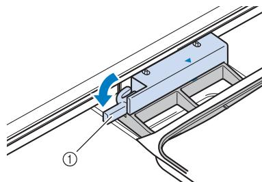
① Palanca de fijación del bastidor
